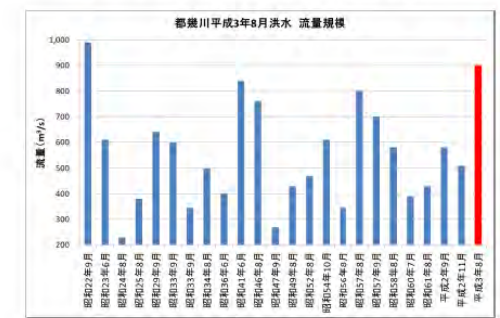
図 2.3.2.12 H3.8洪水の流量規模
